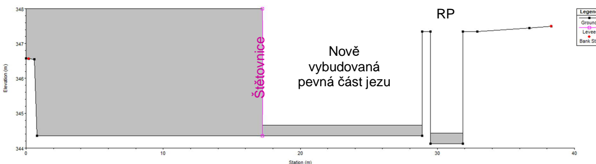
Obr. 2. Schéma průtočného profilu v místě jezu při převodu pravým polem a RP:
